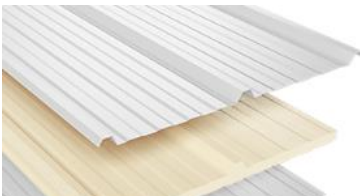
Imatge 09. Imatge de coberta sandvitx insitu composta per xapa grecada + llana de roca + xapa grecada lacada en exterior.
